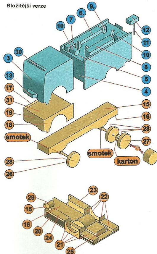
Do zadní části nástavby 4 vlepte pochůzkou plošinu 5. Dále přilepte boky. Při lepení si můžete vypomoci kouskem kartonu o tloušťce 1,5 mm, který zasunete do boků nástavby. Neuzavírejte přední část nástavby! Dále do nástavby vlepte podlahu z dílů 20, 21 a 22. Nakonec přilepte přední část. Dále nalepte díly 23 a 24 a filtr 29, který lepte na díl 24.
